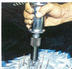
Ejemplo de extracción de abolladuras con el desabollador manual.
