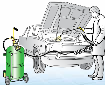
Nebulización de detergente para lavado de motores caudal aprox. de la boquilla 1 - 1,5 l/min
