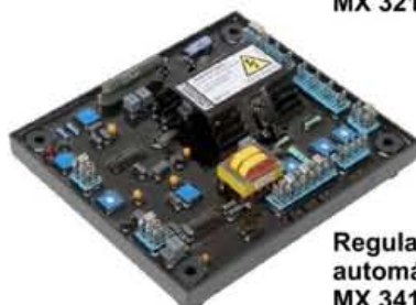
Regulador de voltaje automático (AVR) MX 321
