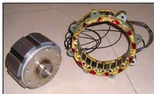
Sistema de generador del imán permanente de Stamford
