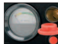
Indicación de nivel de carga y recarga de toma de 12 V.
