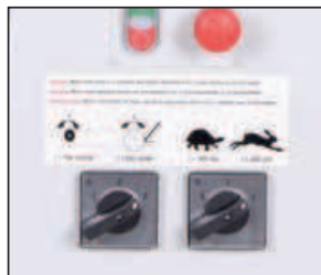
· Fácil control de las dos velocidades de banda para lijar acero y acero inoxidable.
