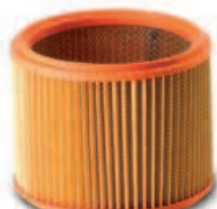
4 Cartucho filtro superficie 1.900m², 12 micro. nom.
