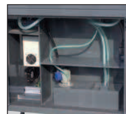
· Para el sistema de refrigerante (40 W). · Capacidad del tanque 12 l.
