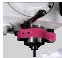
· Cambio sencillo de herramientas mediante dispositivo de extracción rápida.
