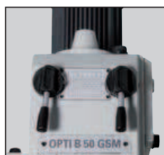
· 9 velocidades regulables mediante la palanca situada en el frontal del cabezal, y un motor de accionamiento en 2 posiciones que proporcionan 18 velocidades.
