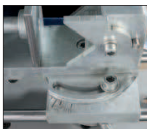
· El ángulo ajustado es legible de forma óptima en una escala.
