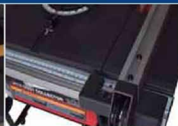
Guía paralela regulación micrométrica
