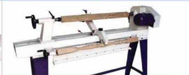
Equipado con copiador mecánico reproduce la pieza a copiar mediante un palpador y una gubia de desbaste.
