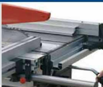
Perfilería en aluminio anodizado, gran precisión de corte.
