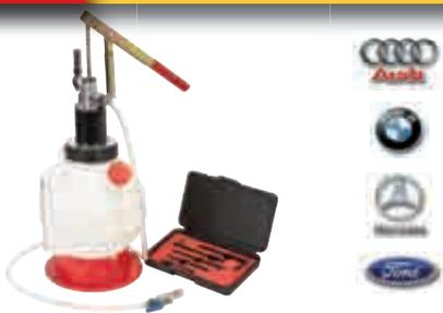
Para Audi, BMW, Mercedes Benz y Ford. Bomba manual fabricada de plástico composite con escala graduada para medir la cantidad de aceite. Suministrado con 5 adaptadores para aceite de transmisiones. Capacidad: 7 lts. Largo de manguera: 1500 mm.
