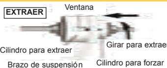
Cilindro para extraer Cilindro para forzar
