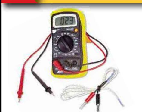
Voltios, corriente DC/AC, resistencia, temperatura, diodos, transistores y continuidad.
