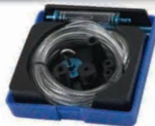
Indicador para encontrar el punto muerto superior de los cilindros de motores diesel y gasolina. Se usa a través de la rosca de bujía o calentador y, al rotar el motor, indica cuando el pistón está en el punto muerto superior.
