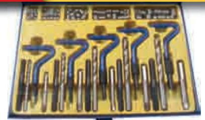
Crea una rosca interna más fuerte en los metales blandos. Ideal para reparar daños o estriado en las roscas internas. Protege a las roscas contra el desgaste y daño. Incluye broca, macho de roscar, instalador y punzón para eliminar lengüeta de instalación. Suministrado con 60 helicoils M5, M6, M8, M10, M12 de 3 largos: 14, 21 y 28 mm.
