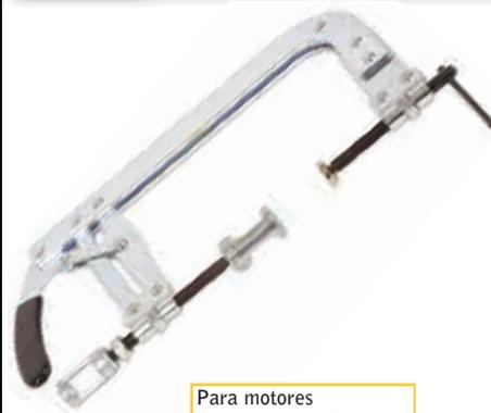
Para motores multiválvulas / Zetec.
