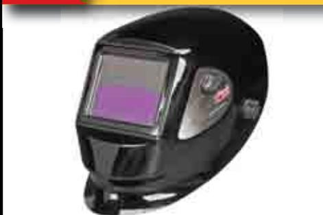
Funciona con energía solar. Oscurecimiento en 0.1ms. Grado de protección variable de 9-13. Sensibilidad y retraso ajustables. Cumple con normas CE y DIN. Apta para soldadura MIG, TIG y ARC. Área de visión 92x42 mm. Peso: 420 gramos.
