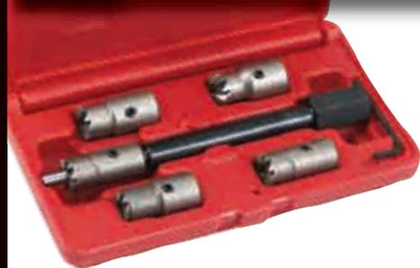
Juego de 5 escariadores para limpiar el asiento del inyector. Medidas: 15x19 mm, 17x17 mm, 17x19 mm, 17x21 mm angular y **NUEVA** corona de 17x17 mm angular.
