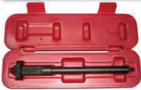
Para quitar el retén de cobre cuando se queda pegado dentro. Para retenes con diámetro interno de 7.5 a 10 mm.
