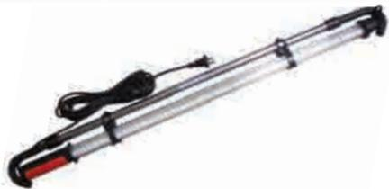
AC230V 50Hz, T5 x 21W. Con interruptor on/off. Gancho y cable de 5 mts. Tubo fluorescente reemplazable que genera iluminación completa del motor. El tubo puede separarse del gancho telescópico para utilizarse por separado.
