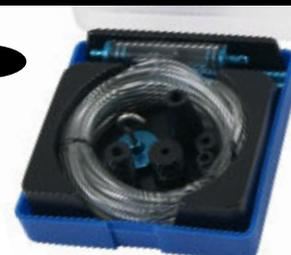
Indicador para encontrar el punto muerto superior de los cilindros de motores diesel y gasolina. Se usa a través de la rosca de bujía o calentador y, al rotar el motor, indica cuando el pistón está en el punto muerto superior.
