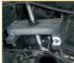
Para extraer inyectores sin desmontar la culata.
