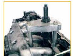
**TK-9061 // Extractor de arandela de cobre de inyectores**
