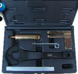
Herramientas esenciales para desmontar la cadena de distribución, para una gama de motores BMW, BMW Mini, Peugeot y Citroën.
