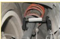
Permite a una sola persona ajustar el ángulo de caída. Medidas: 130-170 mm, 148-180 mm y 170-220 mm.
