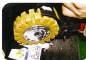
Con el disco borrador eliminaremos fácilmente todo tipo de adhesivos o masillas.
